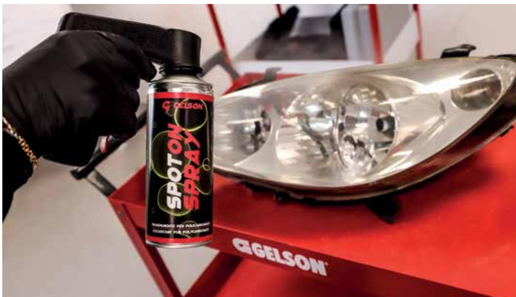
Da sinistra: prima dell'applicazione **rimuovere opacità e ingiallimento** dalla superficie trasparente del faro con una carteggiatura delicata e una pulizia accurata
